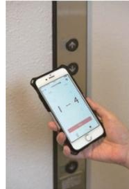
エレベーターホールに近づくと自動でエレベーター呼び出し、ボタンに接触せずに登録階へ昇降可能
