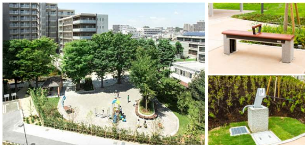
コーシャハイム向原・向原ガーデンコート (2010・2014・2018年度竣工) [左] 一時避難場所となる広場 (既存樹木の保存) [右上] かまどベンチ [右下] 防災井戸
